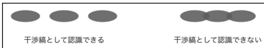
図 13 光源の太さによる明点のぼやけを考慮した上で、干渉縞が認識できるかどうか。左側では、ぼやけた明点同士が重ならず区別できる。一方、右側ではぼやけた明点同士が重なってしまっ、全体に明るく照らされるだけで干渉縞としては認識されない。
