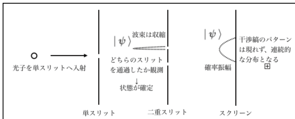
図 19 二重スリットのどちらのスリットを通過したか観測すると、波束が収縮し、二重スリットを通過しても上下の各スリットを通った状態の重ね合わせではなくなってしまう。すると、スクリーン上での存在確率は、連続分布となり、干渉縞のパターンは現れない。
